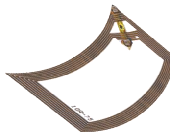
Рис.2. Образец этикетки-носителя и электронного паспорта изоляционных материалов
